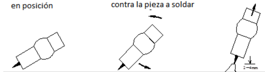
Ignición de TIG raspado
